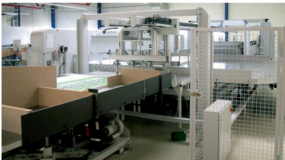
Bei der Installation in der Firma Arian wird das großformatige Schneidgut über den Hintertisch zugeführt. Dem Schnellschneider GH-420 ist der Schüttelautomat BSB 15-S vorgeschaltet.
