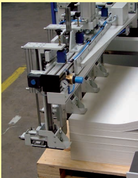
Der Abstapelanschlag des BA 8 hat hohe Ansprüche zu erfüllen. Das System wurde mehrfach durch Lichtschranken gesichert.
