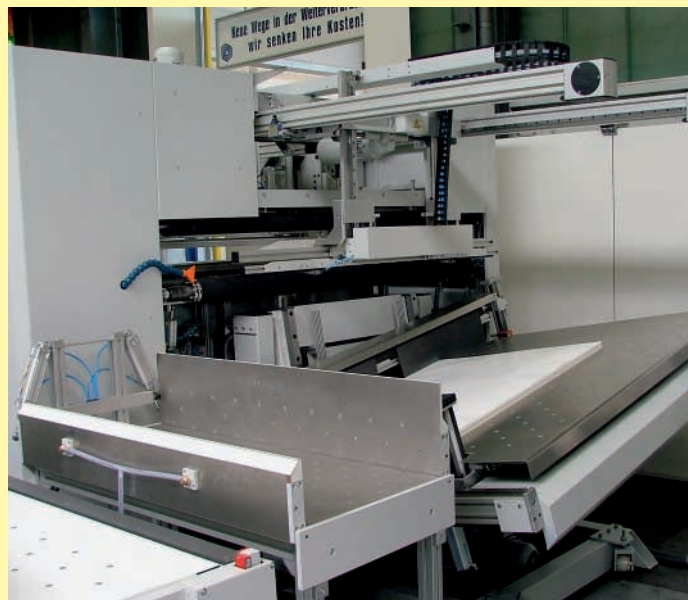
Die BASA 7/8 beim Schütteln einer Lage. Auf der Hausausstellung war die vollautomatische Schüttelmaschine offline zu sehen, kombiniert mit einer detailliert ausgearbeiteten Version des Präzisionsabladers BA 8.
