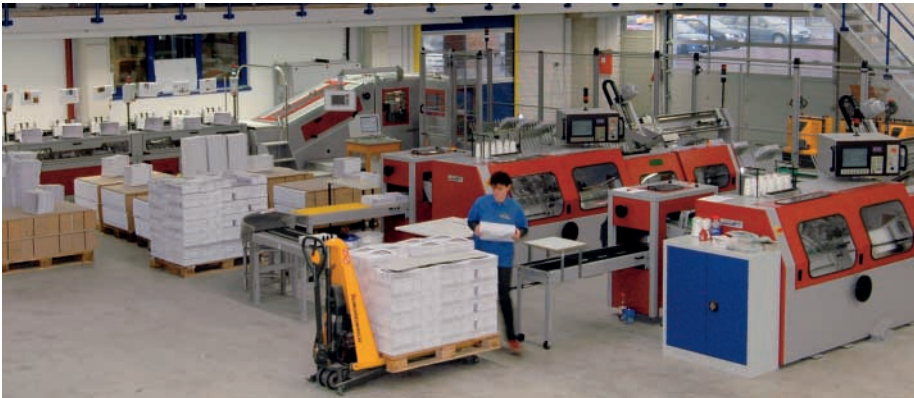
Das automatische Fadenheftverbundsystem »Connect« von Müller Martini ist ein wichtiges Produktionsmittel, weil 70 Prozent der Blocks in dieser Weise gebunden werden.
