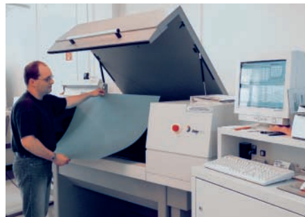
Mit dem CtP-Belichter von Basyprint (UV-Setter 710 HS) können weiter konventionelle Platten genutzt werden.
